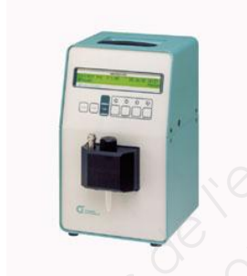
Figure 1 : Microviscosimètre à chute de bille automatisé.
